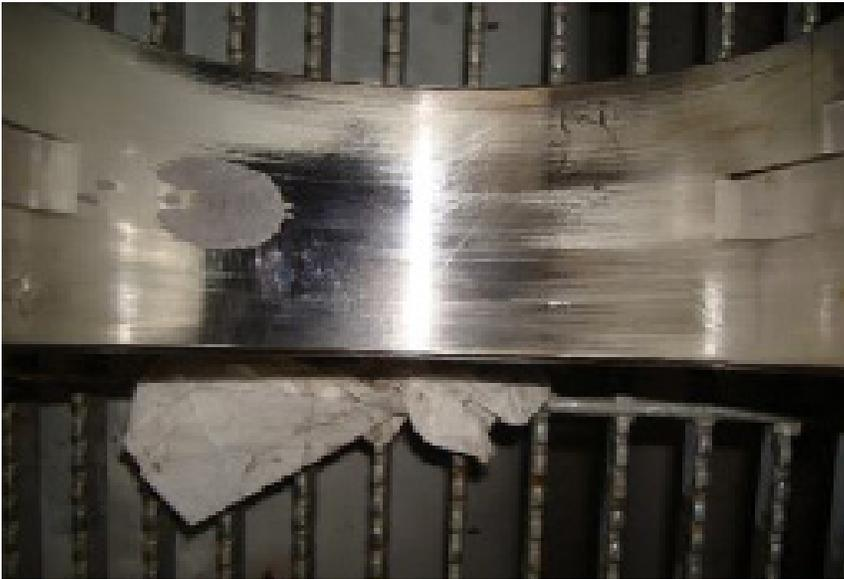
**Fig 4.** Desgaste abrasivo cojinete bancada. Fuente: Propia
