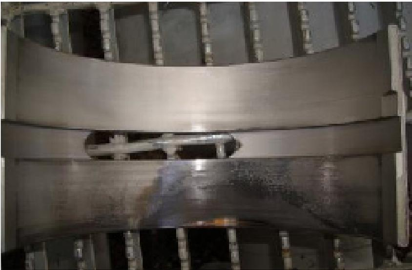
**Fig 5.** Desgaste adhesivo cojinete biela. Fuente: Propia
